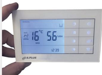
Pour un contrôle optimal du rafraîchissement dans le bâtiment, le rafraîchisseur est raccordé à un thermostat programmable.
