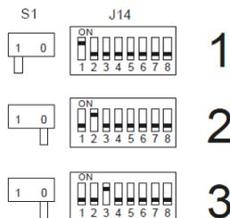
Figure 11 - Connexion de plusieurs aérothermes à un thermostat d'ambiance modulant unique
