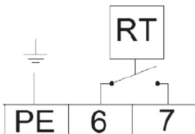
Figure 13 - Connexion d'un thermostat ON/OFF
