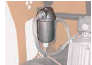
Filtre fioul préchauffage
