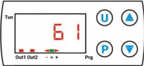
Le Thermostat de contrôle est programmé pour faire démarrer et éteindre le ventilateur principal automatiquement jusqu'à atteindre la température souhaitée de la chambre de combustion. Cela empêche d'envoyer de l'air froid quand le brûleur démarre et que la chambre de combustion n'est pas encore suffisamment chaude, et cela assure l'évacuation de la chaleur interne résiduelle au moment de l'extinction. La température programmée par le constructeur est de 35 °C, avec une hystérésis de 5 °C.
