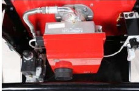
Enlever la bride D avec le joint E déjà montée précédemment sur le couvercle du brûleur et l'introduire en la faisant coulisser sur le tuyau d'adduction du gaz
