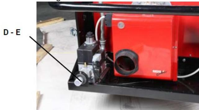
Brancher le tuyau flexible en acier inoxydable au brûleur en ayant soin d'introduire correctement le joint N pour gaz :
