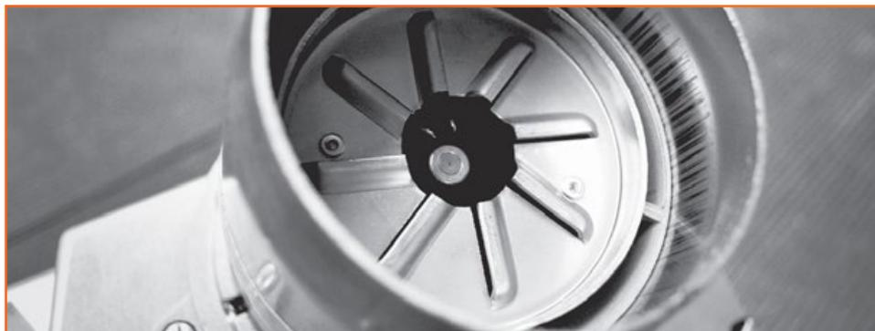
Chambre de combustion en acier inoxydable et parcours des produits de combustion en acier haute température
